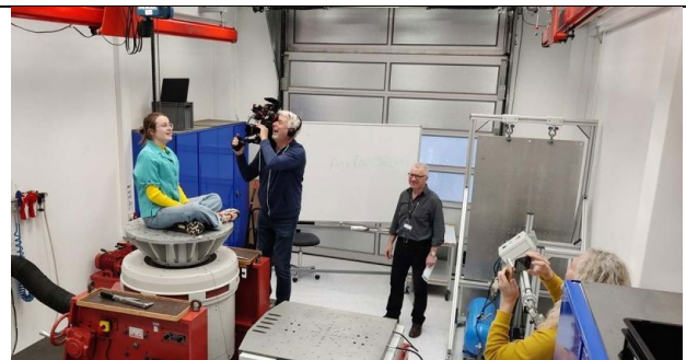
Hovedparten af filmen blev optaget på Termas virksomhed i Lystrup ved Århus. Det er her de afprøver i praksis, om de teoretiske modeller holder. Blandt andet skal alle genstande afprøves på et rystebord, som Nicoline her er sat op på. Det kørte ikke med helt så mange g som ved afprøvning af stjernekameraerne.
